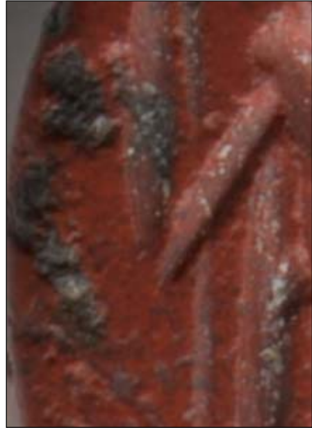
Fig. 10. Detaliu cu silicolit înalt, aspect sticlos, relativ uniform distribuit în masa de silicolit roșu sau dispus sub forma de agregate granulare submilimetrice (stânga, sus), în proba R.7717
